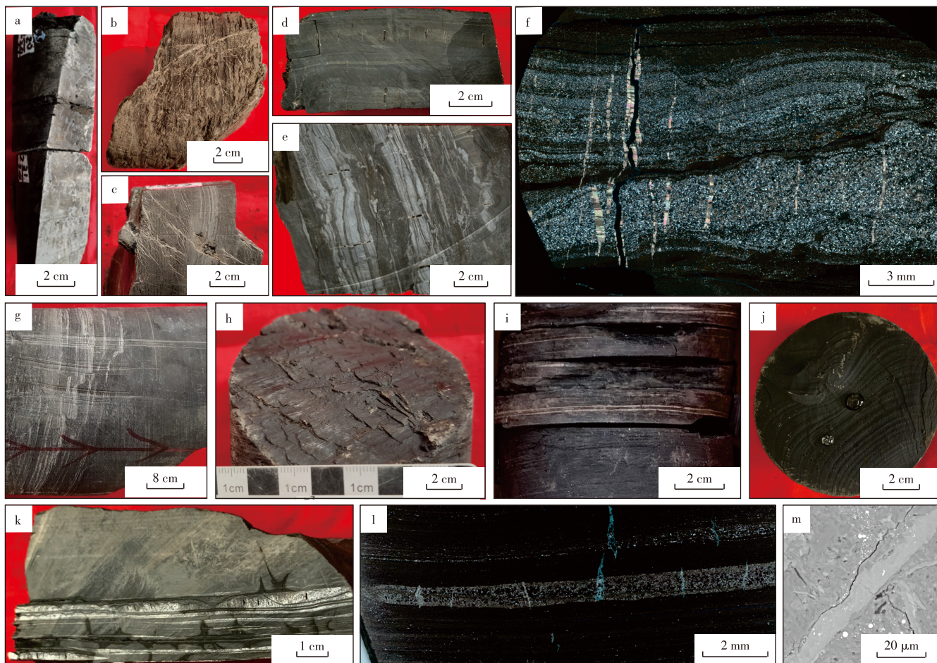
注:a为大型剪切缝, HY7井3 974.2 m; b为树枝状张性缝, HY7井3 987.3 m; c为张性缝, HY7井4 047.54 m; d为白云石条带内张剪缝, HY7井4 146.47 m; e为长英质纹层内张剪缝, HY7井4 040.0 m; f为长英质纹层内张剪缝, HY7井4 142.39 m; g为小断层, HY7井4 149.32 m; h为滑脱缝, HY7井4 021.25 m; i为层理缝, HY7井4 124.0 m; j为层理缝面含油, HY7井4 107.34 m; k为顺层方解石脉, HY7井4 023.68 m; l为顺层方解石脉内溶蚀缝洞, HY7井4 230.19 m; m为粒缘缝, HY7井4 036.1 m。
